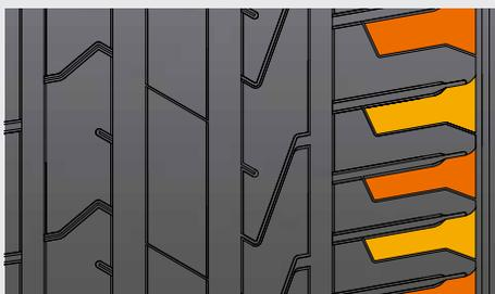
Reducción del ruido gracias a un diseño óptimo de la inclinación.
