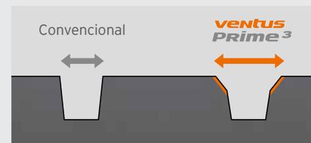
La superficie de contacto se ensancha instantáneamente al frenar, gracias al bisel de los surcos.
