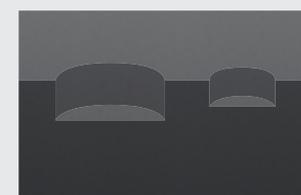
Las marcas del indicador que tienen diferentes profundidades pueden ayudar a identificar fácilmente el grado de desgaste del neumático
